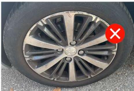
Rayure  $\geq$  10 cm sur la surface totale de la jante, ou  $\geq$  3 cm sur les bâtons, ou arrachement de matière.
