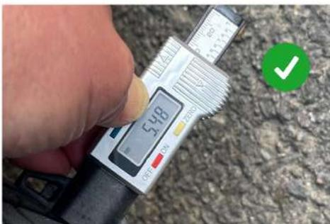
Épaisseur des bandes de roulement du pneu > à 4 mm. Pneus ÉTÉ homologués par le constructeur.
