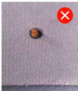
Intérieur dégradé avec des brûlures profondes (cigarette, etc) et des déchirures > 2mm, ou tache indélébile.
