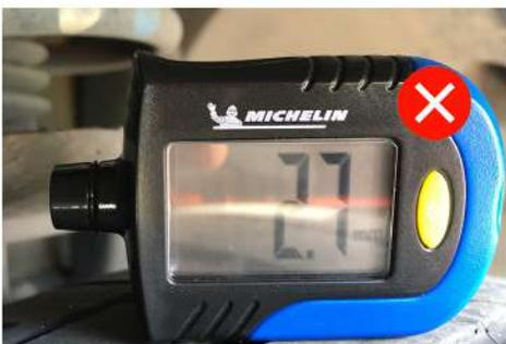
Épaisseur des bandes de roulement < 4 mm, déchirure, entaille, bosse. Pneus non homologués par le constructeur.
