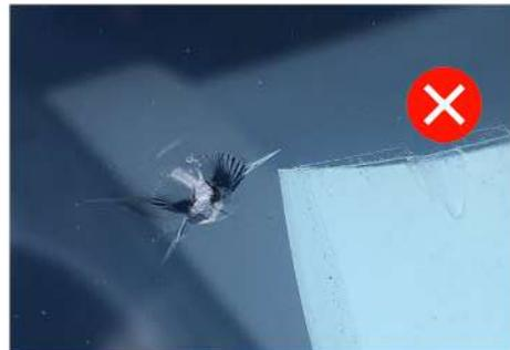
Eclat de diamètre  $\geq$  2 mm, ou dans le champ de vision du conducteur.
